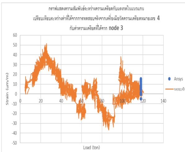
รูปที่ 11 กราฟเปรียบเทียบความเครียดระหว่างเครื่องมือวัดความเครียดหมายเลข 4 กับค่าความเครียดที่ได้จาก node 3
